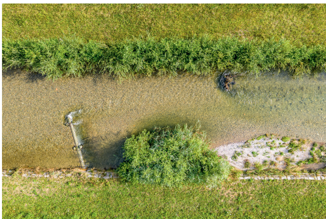
Abbildung 8: Einseitige Kiesbank und Niederwasserrinne auf der gegenüberliegenden Seite mit umströmtem Wurzelstock. Figure 8: Banc de gravier unilatéral et chenal d'étiage sur le côté opposé avec souche submergée.
